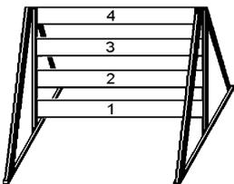
2 Meter hoch und 1,50 Meter breit mit 4 waagerechten 15 Zentimeter breiten Brettern an zwei senkrechten Stützen.
